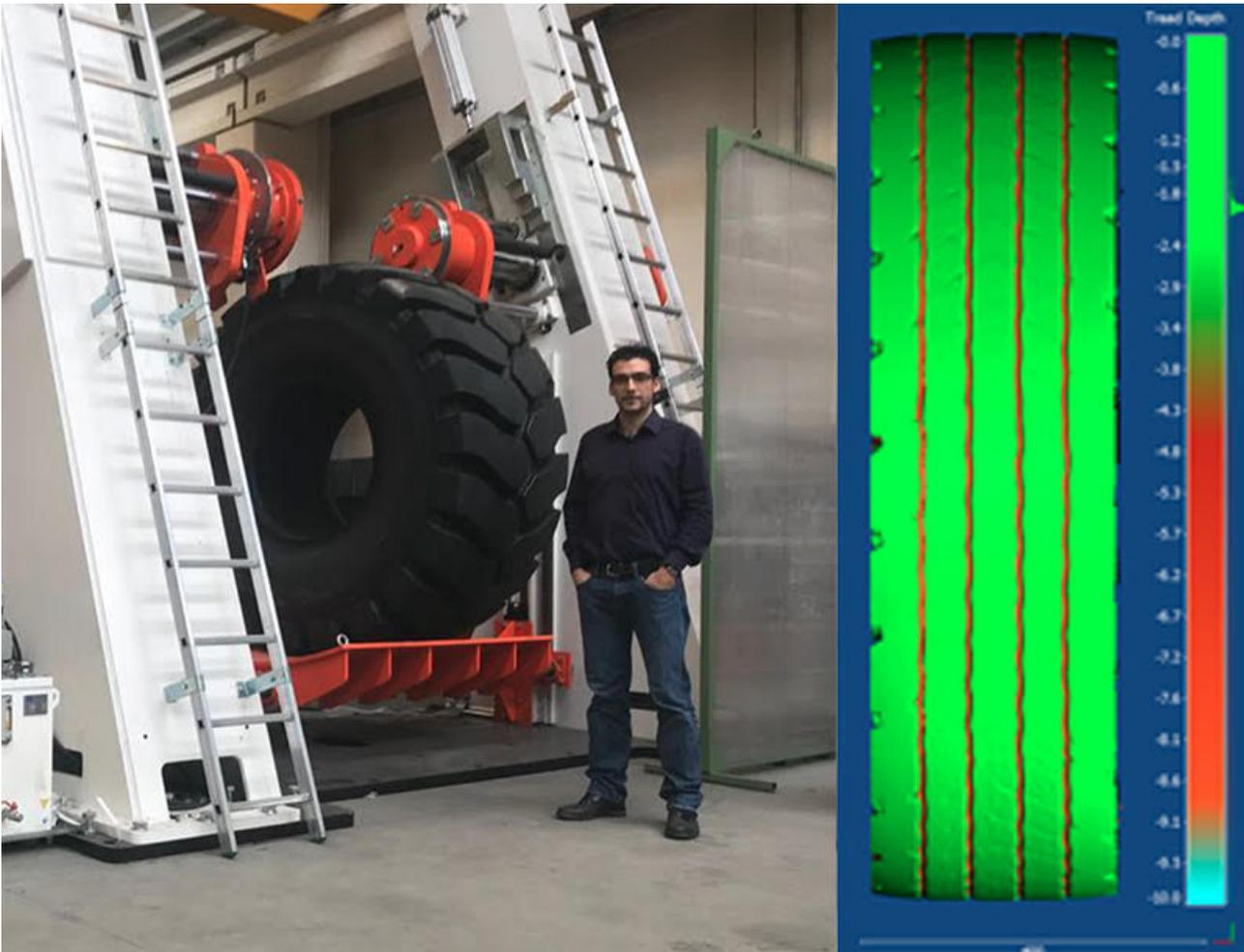
Produzione di pneumatici dove la metrologia 3D e' fondamentale per assistere il processo di rigenerazione.
